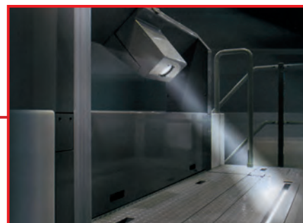
PQA-S (Print Quality Assessment System) 印刷中の品質検査で損紙の混入を予防します。
